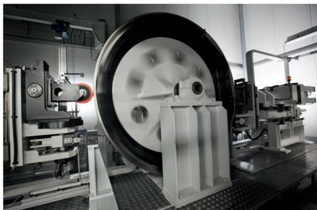
Zur kontinuierlichen Optimierung unserer Prüf- und Testkapazitäten setzen wir einen Trommelprüfstand für Räder und Rollen ein. Dieser ermöglicht es uns, das hohe Qualitätsniveau unserer Produkte zu validieren und weiter zu verbessern.
